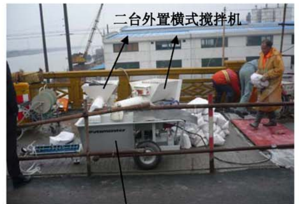
S5EF 电机功率：7.5kW，排量 90l/min 二台搅拌机排量，抵不过 S5EF 的排量
